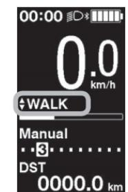
**Attention:** Un carillon d'avertissement retentira pendant la permutation s'il n'est pas possible de passer au mode [PIED] car la vitesse actuelle n'est pas de [0 km/h], ou si une pression est exercée sur les pédales, etc
