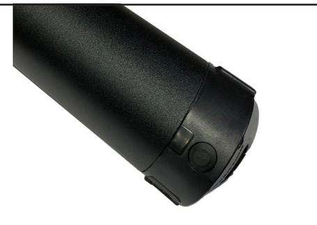
Para comprobar si la batería tiene carga sin tener que conectar la E-BIKE o con la batería extraída solo tenemos que pulsar el botón de la parte inferior. En caso de que tenga carga se encenderá un LED de color azul justo arriba del botón.
