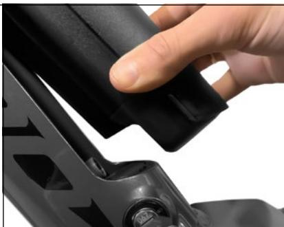
Guarde la batería en un lugar seco a temperaturas de entre 5 y 20 °C. **El estado de carga deberá ser del 70 % de la capacidad total de carga.**
