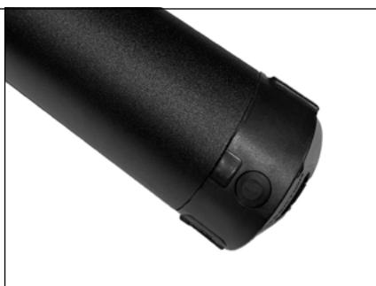
Para comprobar si la batería tiene carga sin tener que conectar la E-BIKE o con la batería extraída solo tenemos que pulsar el botón de la parte inferior. En caso de que tenga carga se encenderá un LED de color azul justo arriba del botón.
