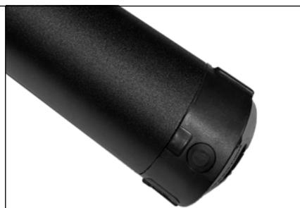
Pour vérifier si la batterie est chargée sans avoir à connecter l'E-BIKE ou avec la batterie retirée, il suffit d'appuyer sur le bouton en bas. Dans le cas où il a une charge, une LED bleue s'allumera juste au-dessus du bouton.
