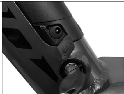
Nella parte superiore della batteria è possibile trovare il pulsante per conoscere lo stato della batteria stessa:
