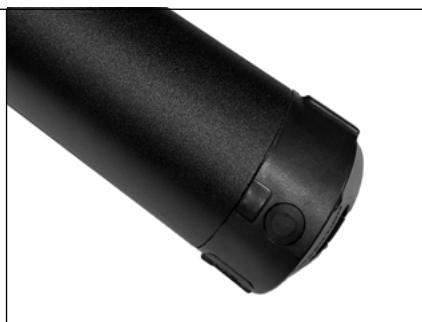
Para verificar se a bateria tem carga sem ter que ligar a E-BIKE ou apenas com a bateria removida temos que pressionar o botão na parte inferior.
