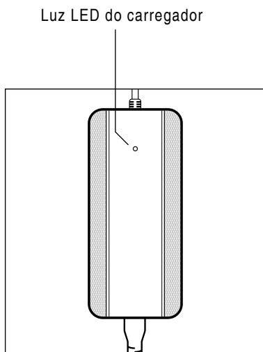
Sempre conecte o carregador à sua bicicleta antes de conectá-la à rede elétrica caso contrário, pode danificar o carregador da bateria e a bateria ficará inutilizável. O carregador de bateria de lítio fornecido com a bicicleta será usado apenas para a bateria recarregável original. Outros tipos de baterias podem causar lesões graves ou danos irreversíveis à bicicleta.
