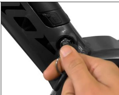
**2** Una volta sbloccata la batteria, è possibile rimuoverla dalla parte bassa.
