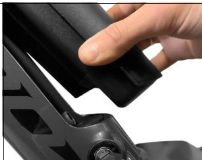
Guarde la batería en un lugar seco a temperaturas de entre 5 y 20 °C. **El estado de carga deberá ser del 70 % de la capacidad total de carga.**
