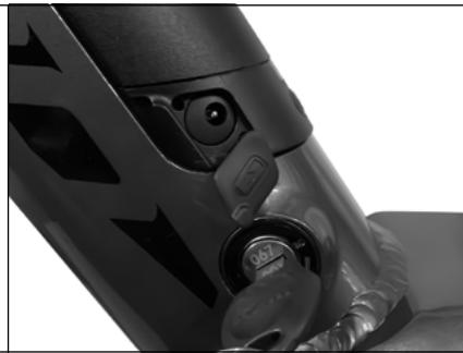
Nella parte superiore della batteria è possibile trovare il pulsante per conoscere lo stato della batteria stessa:
